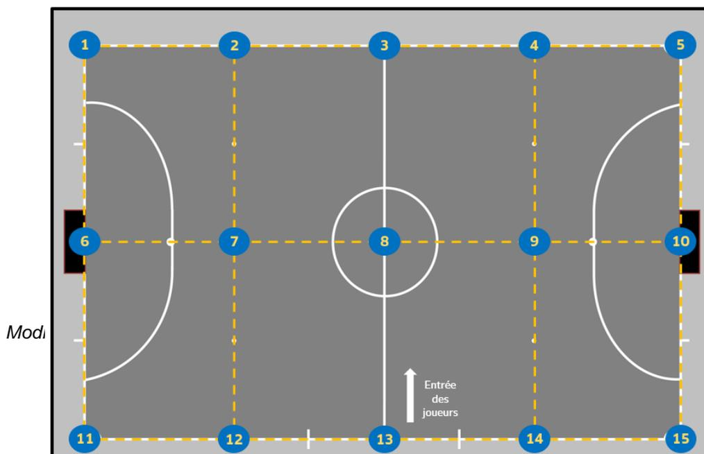
Figure n°3 - Mesure de l'éclairage horizontal, niveaux EFutsal 1 à EFutsal 4
