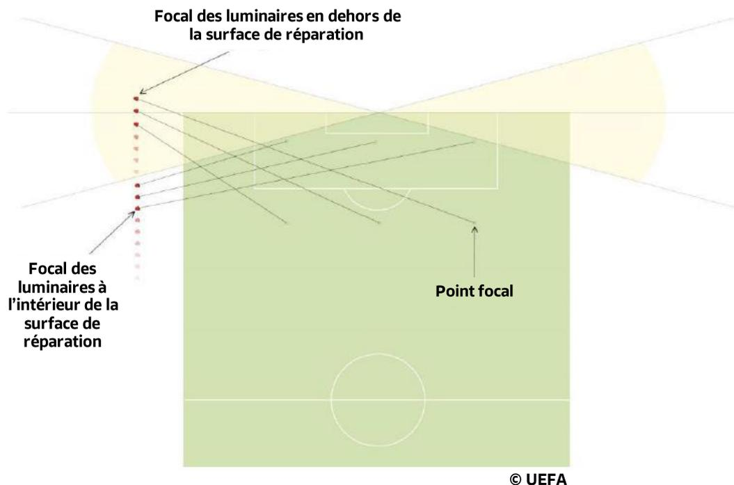
Figure n°9 - Focal des luminaires dans la zone déconseillée
