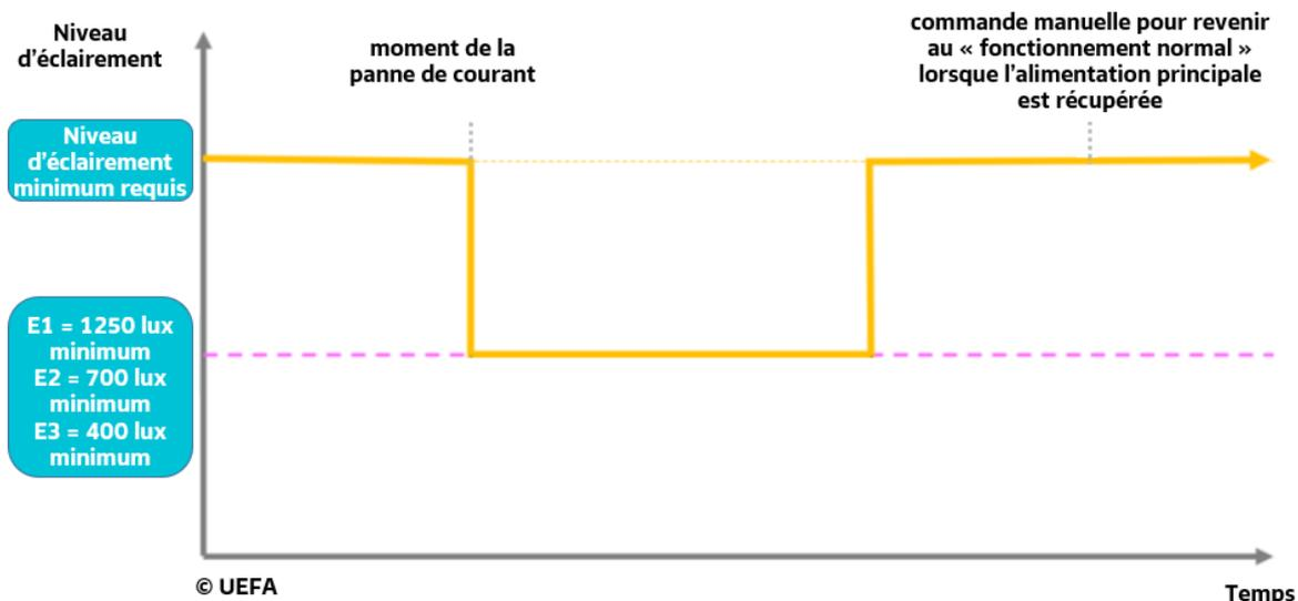
Figure n°16 - Substitution : reprise partielle des sources
