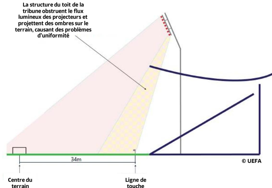
Figure n°7 - Ombre portée par les structures
