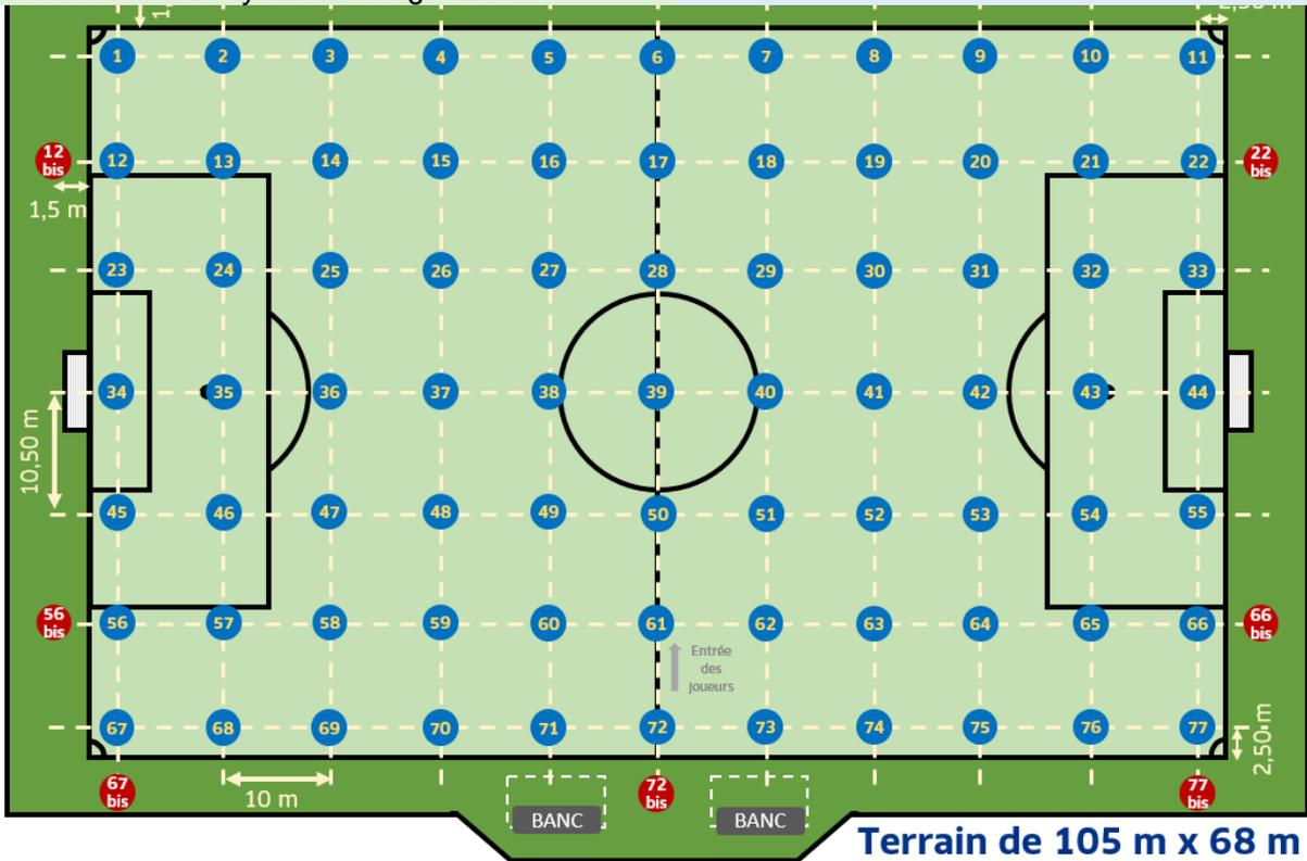
Figure n°1 - Mesure des éclairages, niveaux E1 à E3
