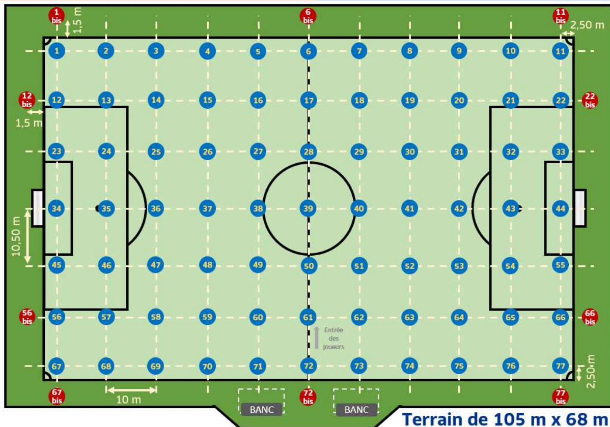
Figure n°1 - Mesure des éclairages, niveaux E1 à E3
